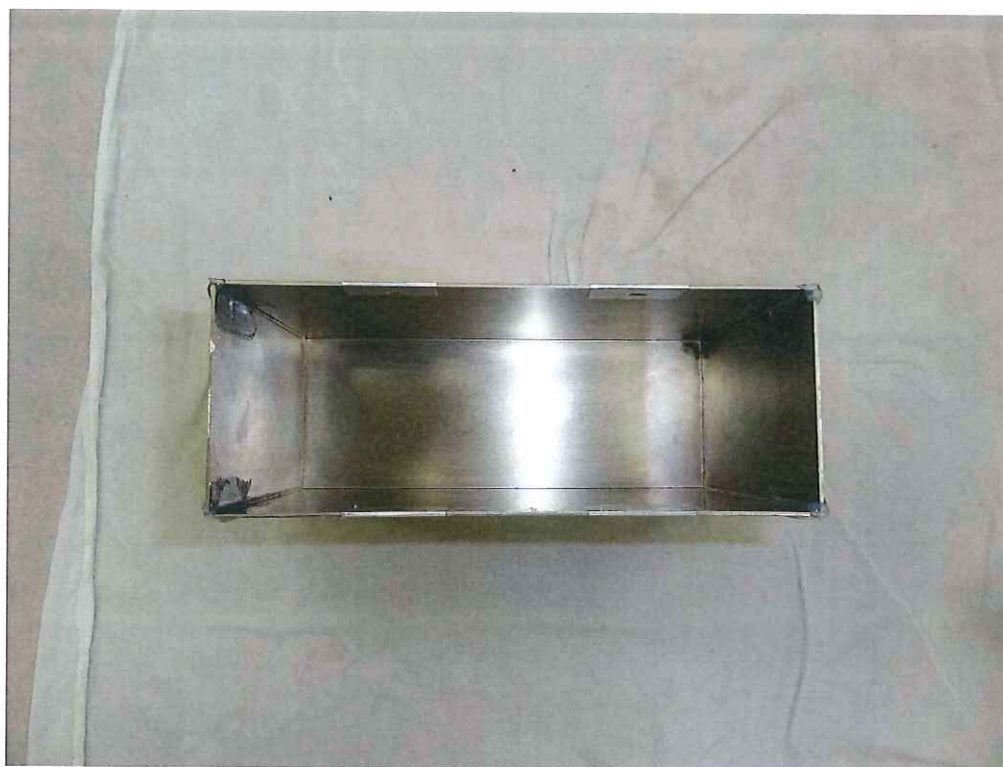
写真 3 IPX7 試験後の内部確認の様子
