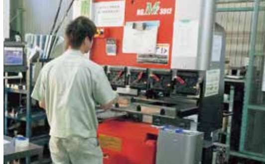
曲げ工程。試作や「電機部」の製品は板金加工に対応する
