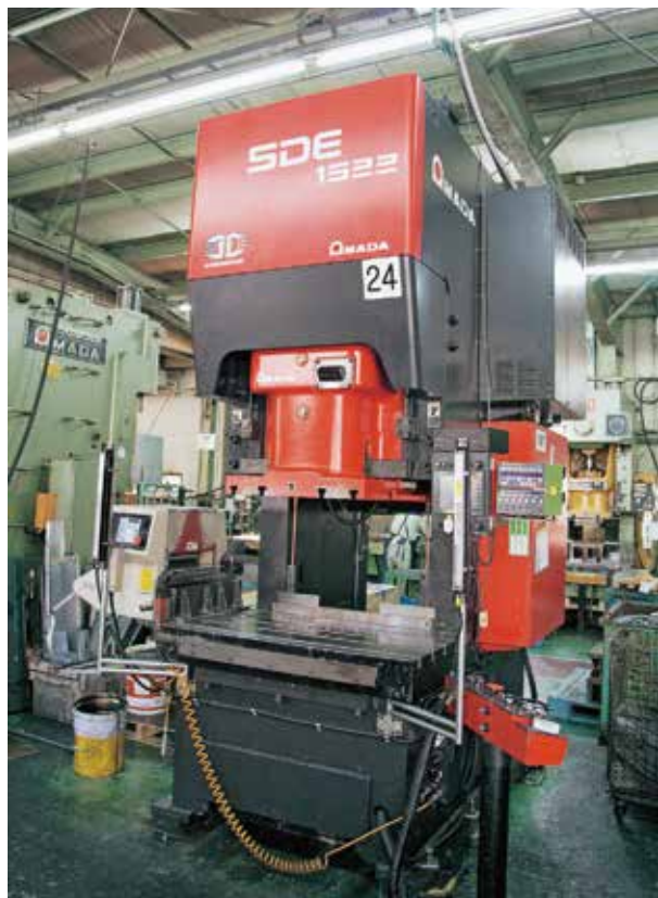
サーボプレス SDE-1522。サーボプレスならではの機能(下死点での一時停止や加工速度・モーションの細かな設定)が「リークゼロコーキング工法」の開発に大きく貢献した
