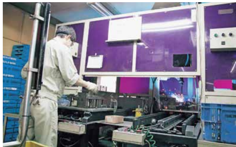
6軸ロボット溶接機を2台設備。移動式のマルチステーションで、加工と段取りを同時に行うことで工数を削減する
